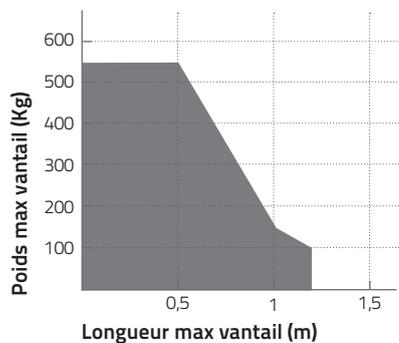
La forme du vantail, l'installation incorrecte et/ou la présence de vent peuvent compromettre les règles d'utilisation indiquée.
